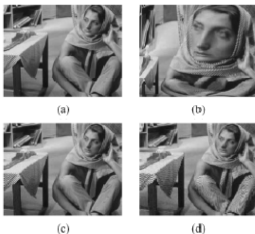
شکل ۲-۵ MDC با استفاده از زیرنمونه برداری چند فازه غیرخطی (a) تصویر اصلی (b) بعد از تبدیل غیرخطی (c) وقتی هر چهار توصیف رسیده باشند و (d) فقط یک توصیف رسیده باشد [26].
